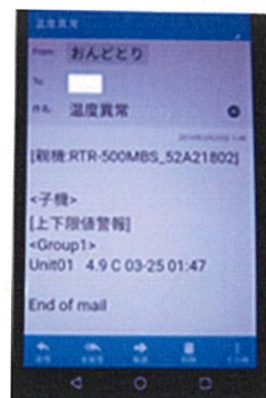
温度異常を伝える警告メール
